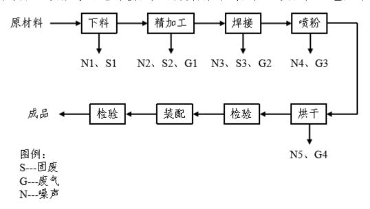
图 2-2 电池焊接生产线设备架子生产工艺流程
