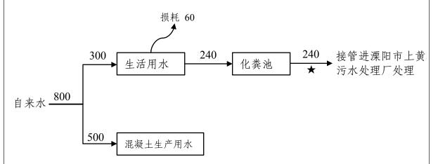
图 2-1 本项目水量及水平衡图 (t/a)
